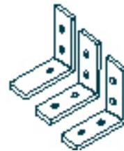
2. Una vez acabada la rampa, pero antes de que el hormigón realice el proceso de secado, debe introducir las piezas en la mezcla, mirando hacia el interior, a lo largo y por ambos lados, manteniendo de 2 a 3cm con respecto al borde, con una distancia de 10cm aprox. entre ellas.
